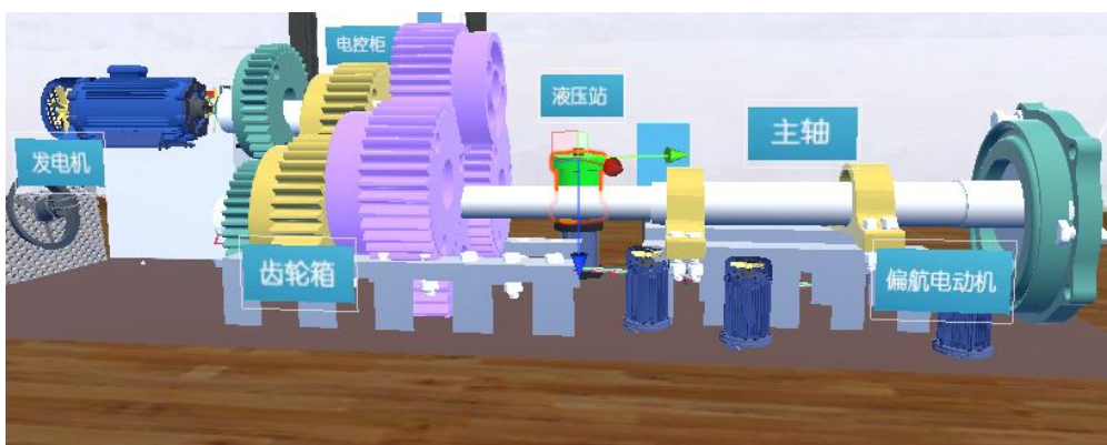
图 3.6 发电机的内部构造场景
